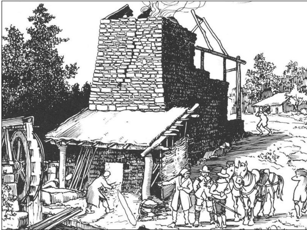
FIGURE 1.4. : haut-fourneau du XVI e siècle. Le fero, devant le fourneau, est en train de couler une gueuse de fonte dans la rigole. Notez aussi la roue à aubes actionnant le soufflet du foyer. Croquis de J. Morette (Bourguignon, 1999, p. 330) d'après Breughel l'Ancien (l'original se trouve à la Galeria Dora Pamphilij à Rome).
