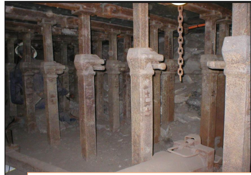
Piles en acier coulissantes sous efforts constants réglables à l'aide de clavettes
